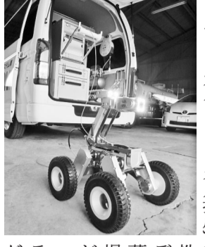
河野真須美社長は、カメラヘッドにはオートフォーカス・12倍ズーム(光学10倍デジタル12倍)と可変式LED照明を搭載。クリアな映像と直視・側視も可能。コンパクトはタッチパネル採用で快適な操作性とハードディスク内蔵し調査現場での記録ができる。
